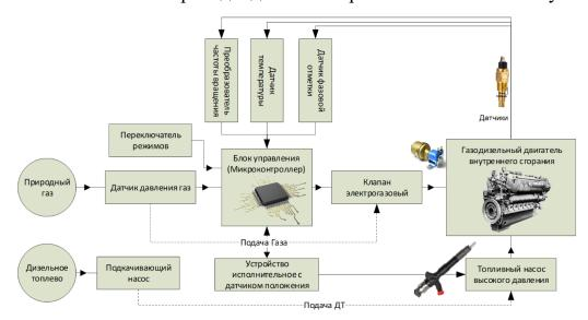
Рисунок 1 — Аппаратура и система автоматизации управления газодизелем силовой установки тепловоза
