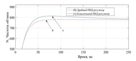
Рисунок 7 — Результаты моделирования ПИД (A) и ПИ $_{\alpha}$ Д $_{\beta}$  (B) алгоритмов управления при частоте 770 об/мин
