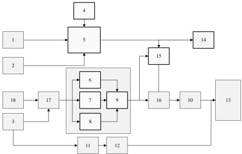
Рисунок 2 — Схема цифрового управления газодизеля силовой установки тепловоза:
