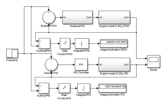
Рисунок 4 — Модель для исследования двигателя Д-242с дробным  $\Pi U_{\alpha} \mathcal{Д}_{\beta}$  и классическим  $\Pi U \mathcal{L}$  регуляторами
