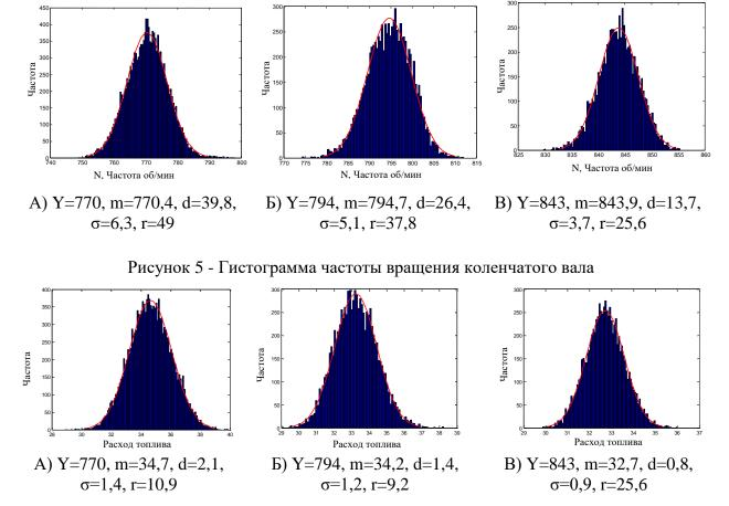
Рисунок  $6 - \Gamma$ истограмма расхода топлива:  $d - дисперсия, r - размах выборки, <math>\sigma -$ среднеквадратичное отклонение, m -математическое ожидание, Y -уставка
