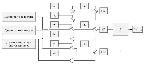
Рисунок 3 — Схема блока диагностики закоксованности выпускных окон, & — блок логического сравнения «И»,  $\otimes$  — сумматор
